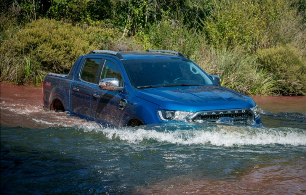
Capacidade de imersão de 800mm e Nova Suspensão. Robustez e conforto
